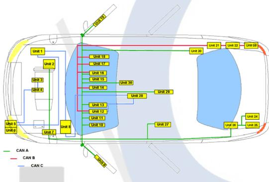
Bild: Beispiel einer Busstruktur
